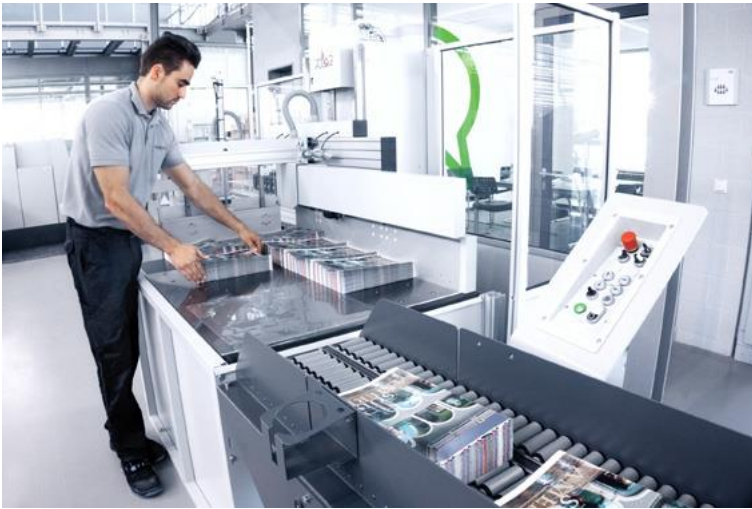
POLAR Transomat TRE zum Abstapeln von Falzbogen
