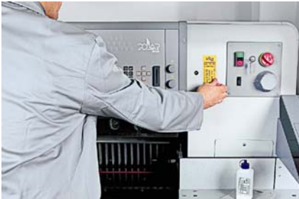
Anbringen der Prüfplakette nach einer Sicherheitsinspektion
