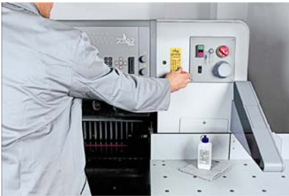
Aufkleben der Prüfplakette nach erfolgter Sicherheits- inspektion
